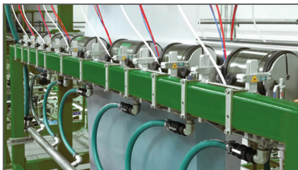
Montaggio su staffa per stampare con più macchine sulla stessa linea Installation on supporting bracket to print with several machines on the same line
